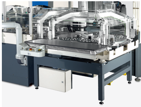
Twin Loader – automatischer Läuferscheibenaustausch für kürzeste Ladezeiten
