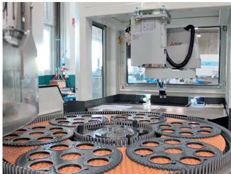
Roboterzelle für eine automatische Be- und Entladung der Maschine – auch kombinierbar mit dem Twin Loader
